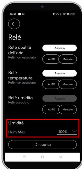
Per configurare l’umidità massima “Hum. Max” premere sull’icona in cui viene visualizzata la percentuale di umidità relativa al parametro. Viene visualizzata la seguente schermata in cui è possibile configurare il parametro.
