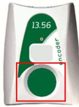
e appoggiare la tag o il radiocomando sulla parte predisposta dell'encoder.
