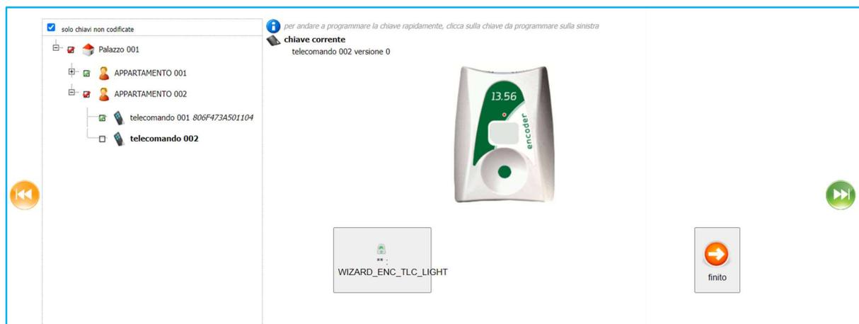
Questa pagina serve per programmare le tag **1088/53** o i radiocomandi **1088/35** tramite l'utilizzo dell'Encoder **1088/200** (vedere il manuale del **1088/200** per l'installazione a PC)
