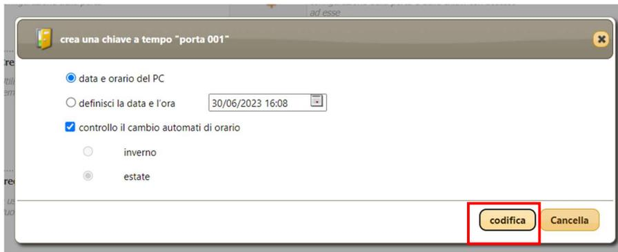
Appoggiare un radiocomando sull'encoder e cliccare sul pulsante **Codifica** per programmarlo. Una volta programmato, premere il primo pulsante del radiocomando per inviare i dati al controller, si udiranno dei bip di conferma dal controller stesso.
