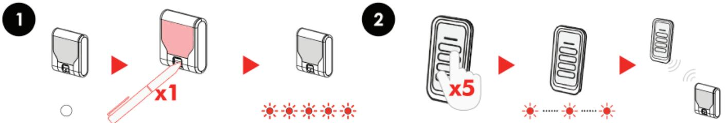
Hinweis: Der Verbindungsaufbau zwischen Sender und Empfänger kann zwischen 5 und 15 Sekunden dauern
