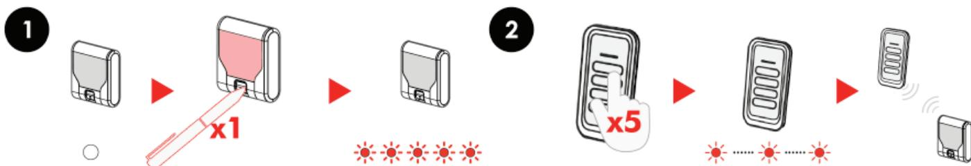
NB: La connessione del trasmettitore al ricevitore può richiedere dai 5 ai 15 secondi
