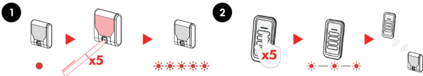
NB: La connessione del trasmettitore al ricevitore può richiedere dai 5 ai 15 secondi
