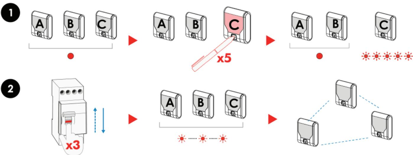
Hinweis: Die Verbindung zum Empfängernetz kann zwischen 5 und 20 Sekunden dauern
