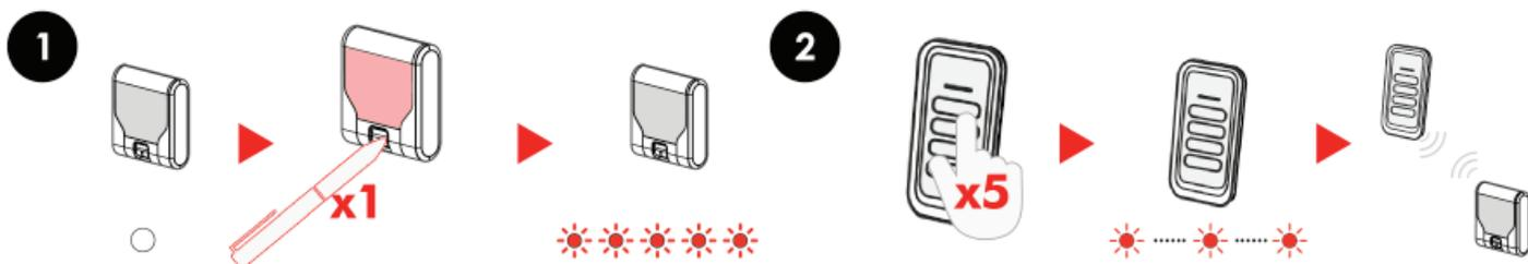
NOTA: La conexión del transmisor al receptor puede tardar entre 5 y 15 segundos
